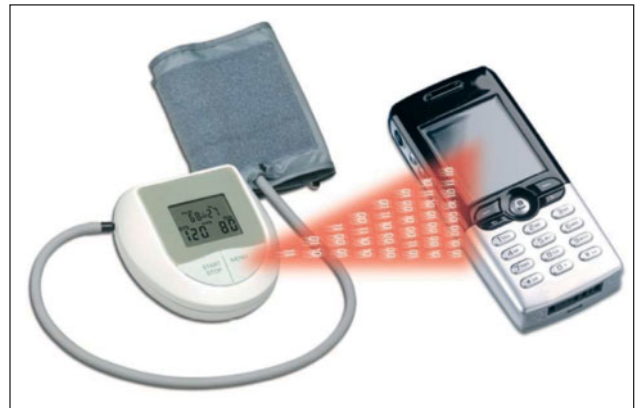
Abbildung 2: Automatische Datenübertragung der Blutdruck- und Pulswerte nach jeder Messung per Bluetooth auf ein Mobiltelefon und vom Mobiltelefon auf einen Server.
